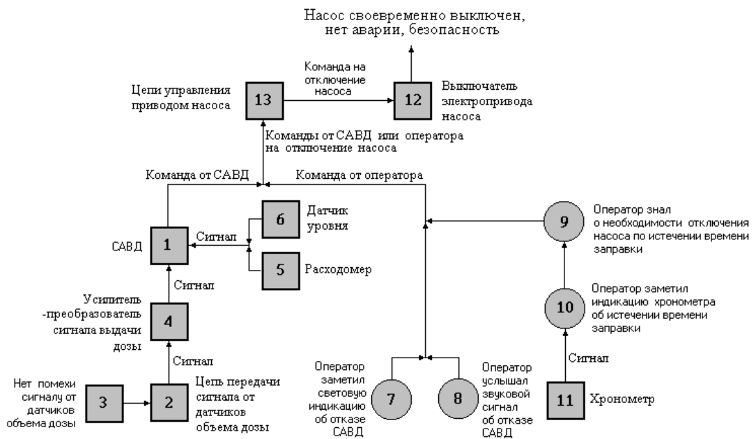
Рис. 12.2. Функциональная блок-схема безопасности заправочной операции
